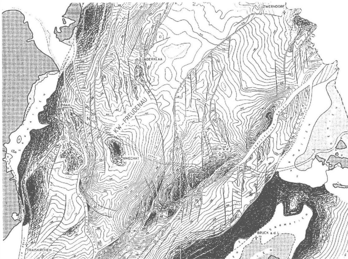
Abb. 3: Tertiäre Beckenfüllung im Zentralbereich des Wiener Beckens und Lage des Kraftwerkes Freudenau am Rande der Schwechater Mulde: Oberhalb der dargestellten Sarmatoberkante liegen pannonische und pontische Tertiärsedimente (Ausschnitt aus einer Karte von H. Unterwiesing, 1979)
