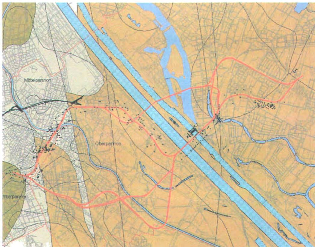
Abb.6: Ausschnitt aus der geologischen Karte nach Brix 1972 (Tertiäroberfläche) mit verschiedenen Varianten der geplanten U2-Verlängerung nach Aspern.
