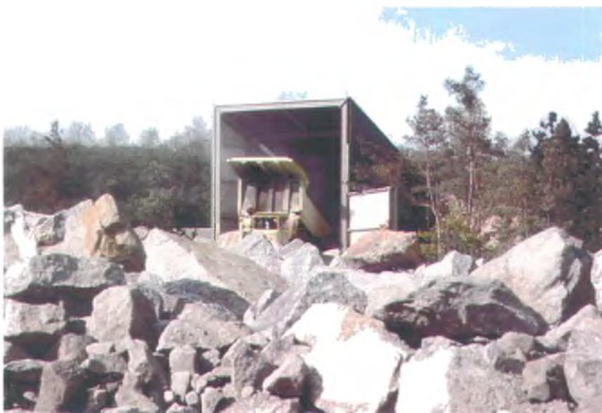
Abb. 32: Ein Muldenkipper schüttet das durch Sprengung gewonnene Haufwerk in den Vorbrecher (Steinbruch Limberg).
