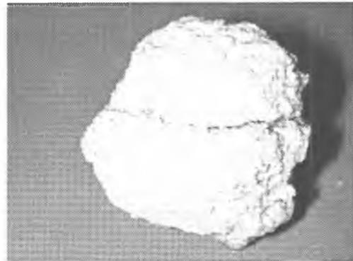
Abb. 49: Beispiel eines Salzkristallisationstests mit Natriumsulfat an Aflenz Kalksandstein.
