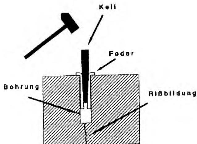
Abb. 18: Funktionsweise eines Federkeiles (aus: SINGEWALD 1992).
