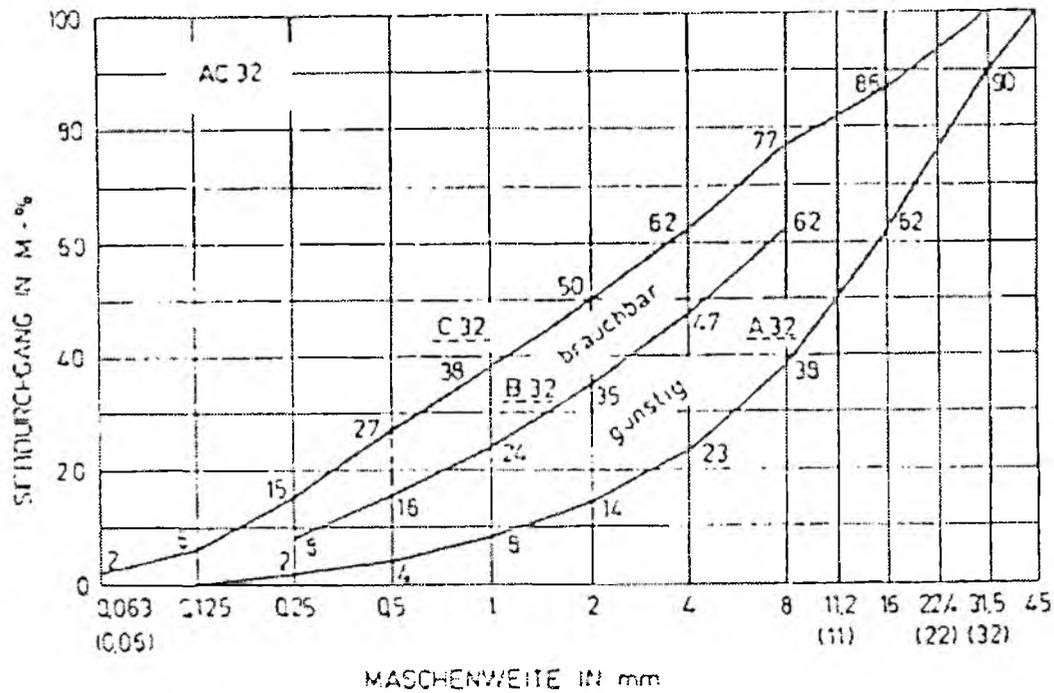
Abb. 37: Beispiel einer Kornverteilungskurve aus der ÖNORM B 4710.
