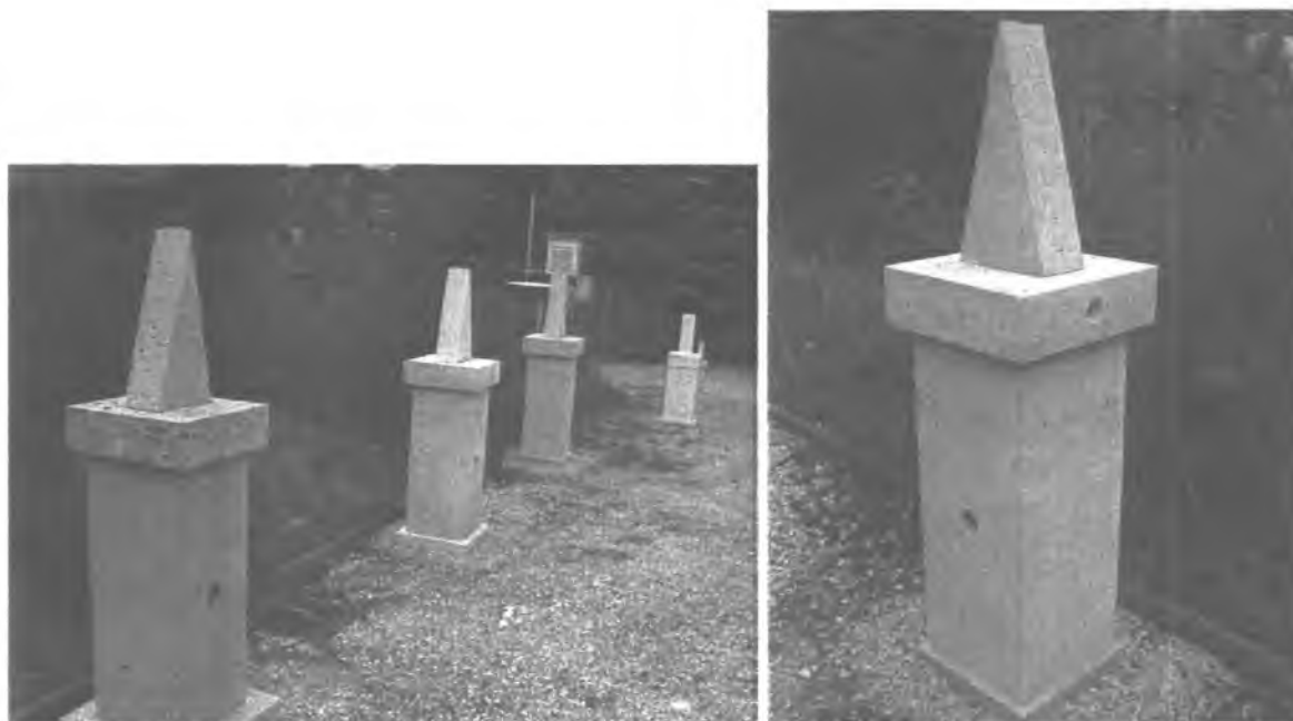
Abb. 9: Freiluftlangzeitverwitterungsversuche auf dem Gelände der Kartause Mauerbach (Bundesdenkmalamt).
