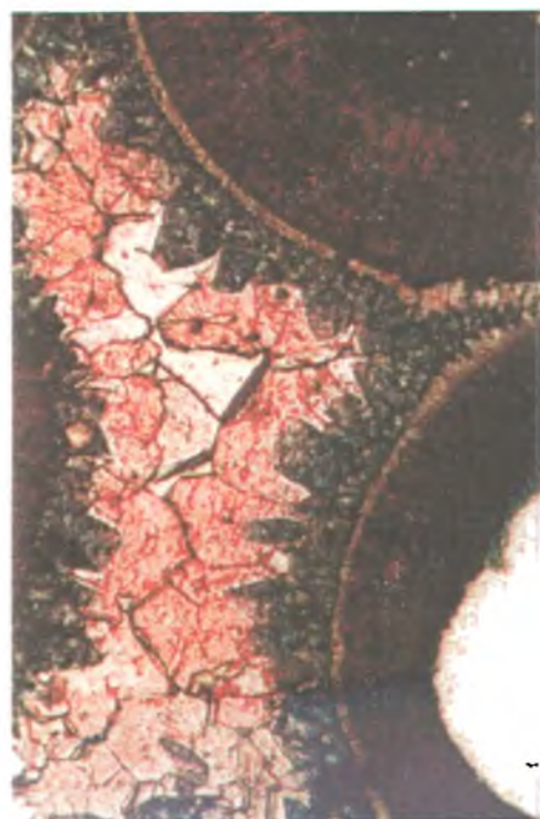
Abb. 36: Links: Dünnschliff eines muschelreichen Atzgersdorfer Steines (Länge des Bildausschnittes ca. 4,5mm, gekreuzte Polarisatoren). Außerdem können Foraminiferen, Quarz (grau) und ein rundes Kalkspatgeröll (bunte Farben) beobachtet werden. Rechts: Selektiv gefärbter Dünnschliff Atzgersdorfer Stein (Länge des Bildausschnittes rund 2mm): Interessant ist die häufig mehrphasige Verkittung der Komponenten des Atzgersdorfer Steines. An diesem Beispiel sind 4 Phasen zu beobachten.
