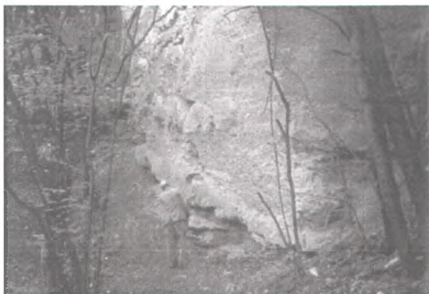
Abb. 52: Schrämmwand im alten Steinbruch von Edelstal. Deutlich erkennbar sind die einzelnen Lagen des genutzten fest zementierten Sandsteines.
