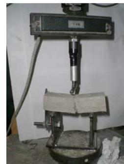
Abbildung 2: Durchführung eines Biegezugversuches
