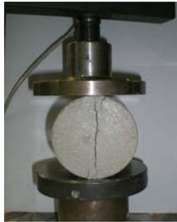
**Abbildung 3: Durchführung eines Spaltzugversuches**
