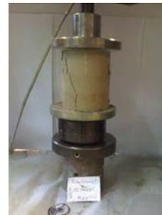
Abbildung 1: Durchführung eines Druckversuches
