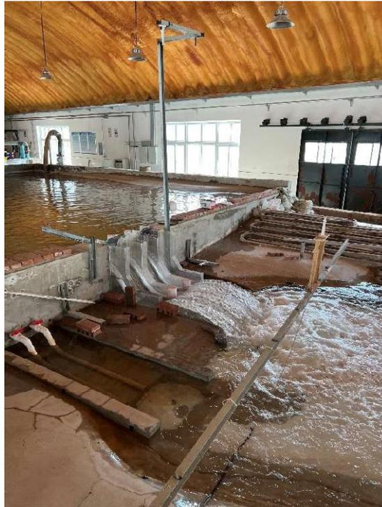
Abbildung 19: Modell der Überlaufsektion einer Staumauer
