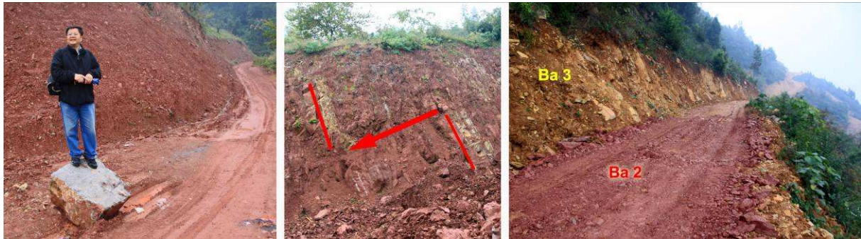
Westlich der Huang Tupo-Rutschung, Links: Prof. Xiang; Mitte: eine Verwerfungszone im Einschnitt; Rechts: die Übergangszone zwischen Ba 2 und Ba 3 [19.10.2011]
