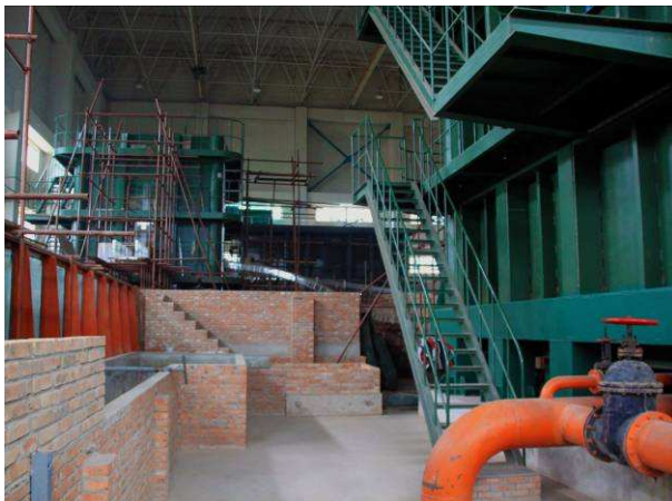
Weishanzhuang, Links: der 13 m hohe Wassertank des Hydraulik-Labors; Rechts: ein Modellversuch der Erkenntnisse über die Hochwasserentlastung und den Energieabbau im Tosbecken eines geplanten Kraftwerkes liefern soll [10.10.2011]
