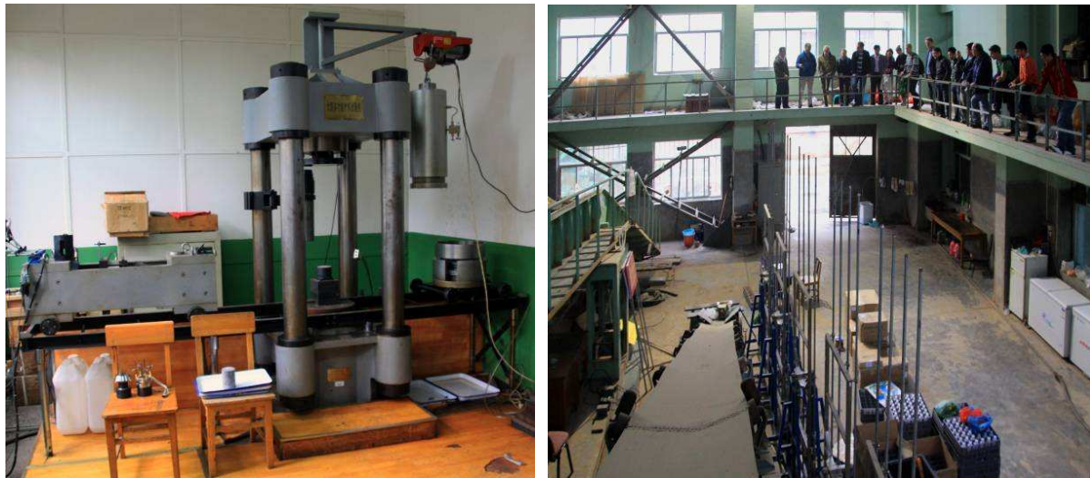
Technische Universität von Xi'an, Links: Kombination aus Schergerät und Triaxialzelle; Rechts: Versuchshalle des Institutes für Wasserressourcen, Umwelt und Ökologie [12.10.2011]
