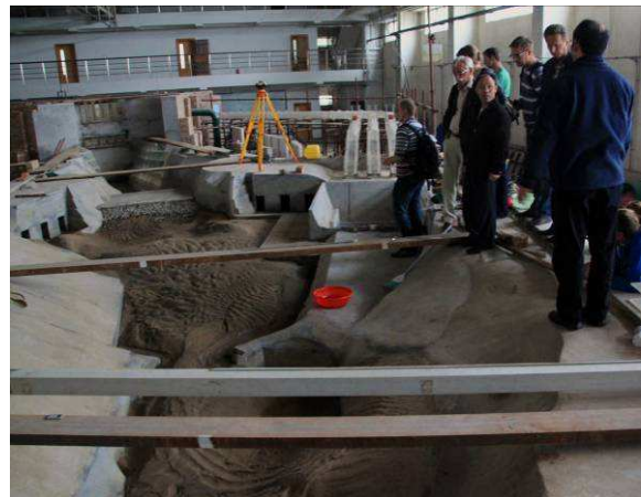
Weishanzhuang, Links: der 13 m hohe Wassertank des Hydraulik-Labors; Rechts: ein Modellversuch der Erkenntnisse über die Hochwasserentlastung und den Energieabbau im Tosbecken eines geplanten Kraftwerkes liefern soll [10.10.2011]
