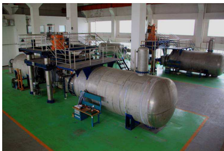
Versuchshalle mit 3 Testanlagen für Turbinenkavitationsversuche; oben rechts: unter Stroboskopbeleuchtung werden Aufnahmen der sich am Turbinenschaufelrad lösenden Dampfblasen gemacht [10.10.2011]
