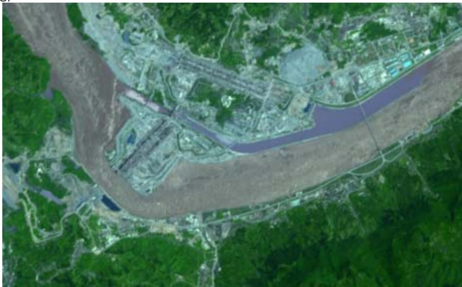
Abb. 6: Satellitenaufnahme der Baustelle im Juli 2000. Zu erkennen ist der trocken gelegte Bauplatz der ersten beiden Abschnitte der Mauer, während der Fluss daran vorbeigeführt wurde.
