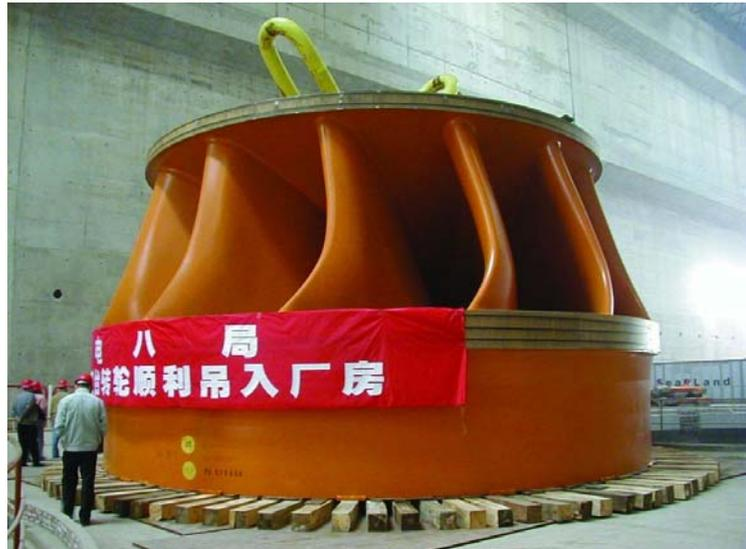
Abb. 11: Francis-Turbine vor dem Einbau. Durchmesser etwa 15m
