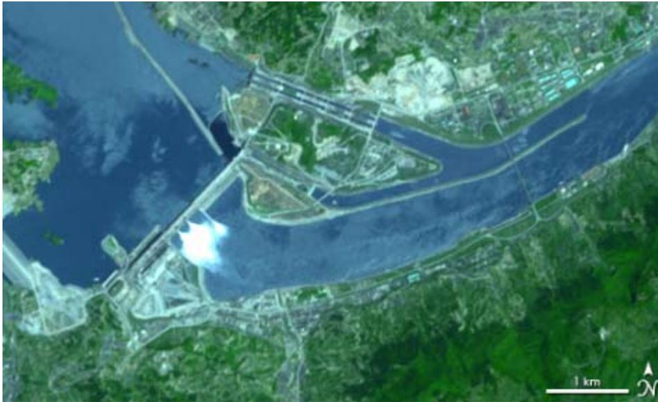
*Abb. 7: Satellitenaufnahme der Baustelle im Mai 2006. Der letzte Abschnitt der Mauer am rechten Ufer ist in Herstellung. Der Fluss fließt über Schotten und Schleusen ab.*
