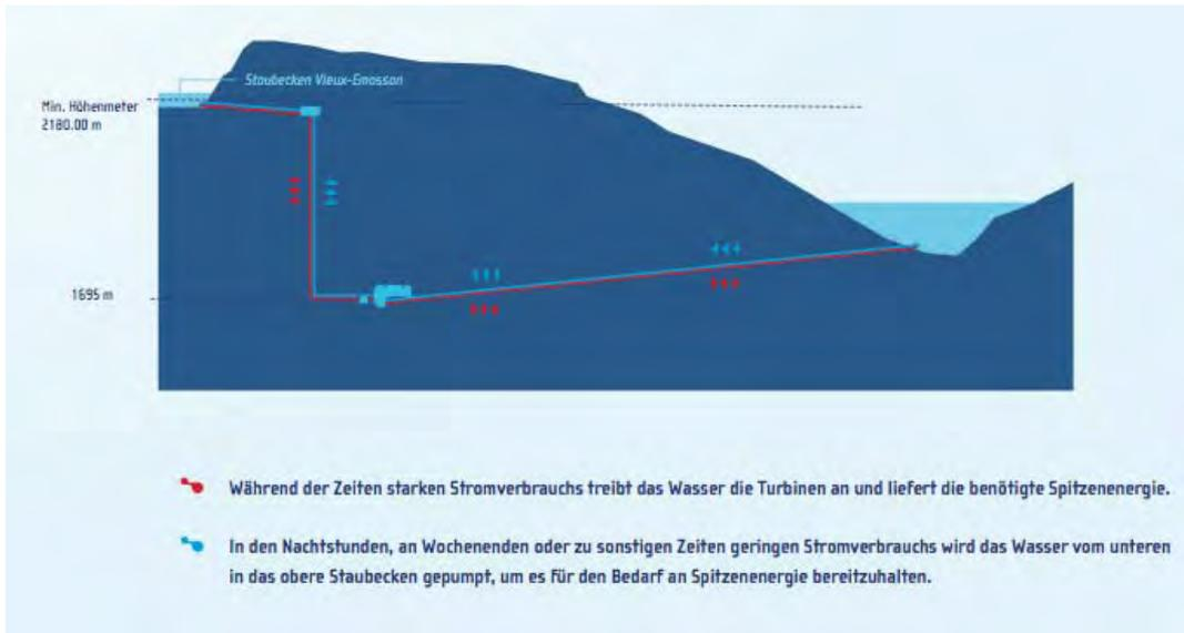
Abbildung 2 Hydraulische Übersicht der Kraftwerksanlage
