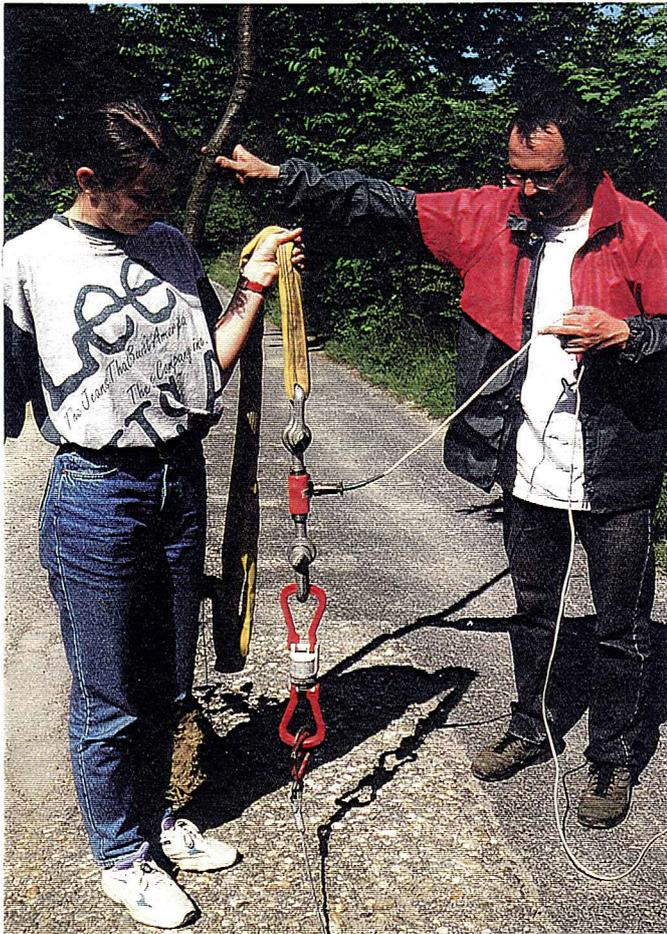
Abbildung 4: Druckabnehmer (Sensor) bis 25kN, links und rechts mit Schäkeln an Gurt bzw. Drallfänger befestigt; in der Mitte des Sensors erfolgt die Weiterleitung der gemessenen Kraft zum Meßverstärker, Konverter und anschließend auf einen Laptop;
