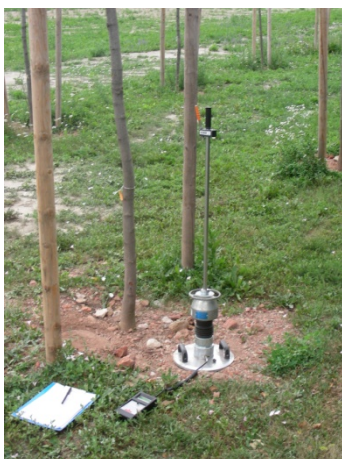
Abbildung 18: Lastplattenmessung vom 24.07.2007 im Versuchsgarten Essling
