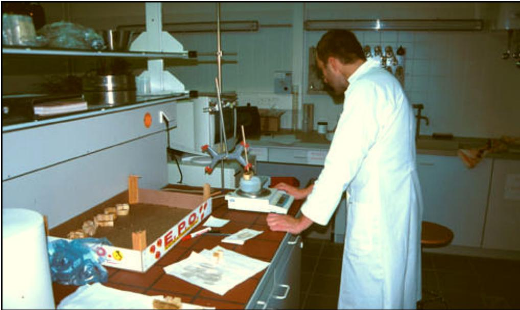
Abb.35: Die Messung des Volumens nach dem Verdrängungsprinzip von Archimedes
