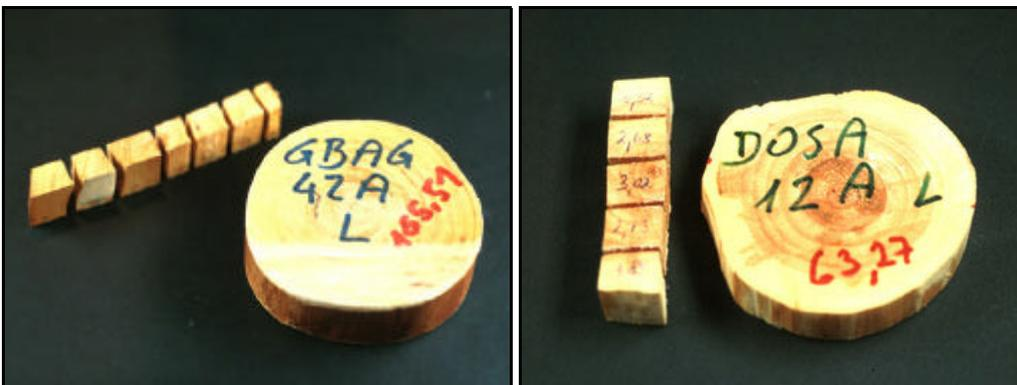
Abb.33: Stammscheiben und Würfel zur Bestimmung der Dichte und der Feuchtigkeit
