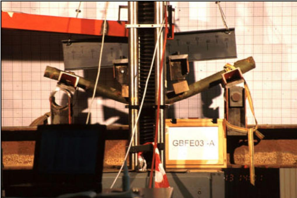
Abb.46: Die Verformung des Probestückes GBFE03A unter einer Belastung von 7,12 kN
