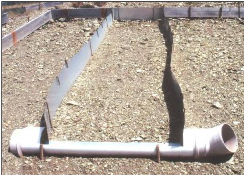
Abbildung 4: Erosionsmessenrichtung
