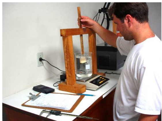
Abbildung 4.4.3.1: Die Messung des Volumens nach dem Verdrängungsprinzip von Archimedes.
