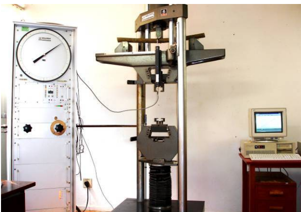
Abbildung 4.4.1: Die einaxiale Biegeprüfanlage am „Departamento de Ciências Florestais / UFSM“, Südbrazilien (links) und Detail eines Probestückes im belasteten Zustand (rechts).
