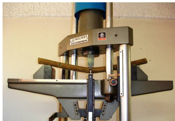
Abbildung 4.4.1: Die einaxiale Biegeprüfanlage am „Departamento de Ciências Florestais / UFSM“, Südbrazilien (links) und Detail eines Probestückes im belasteten Zustand (rechts).
