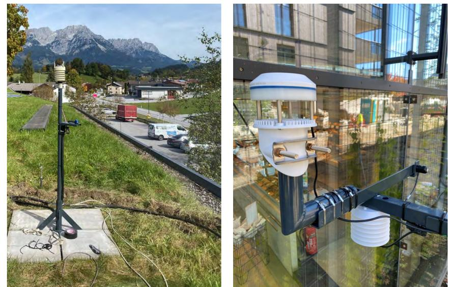
Abb.3&4: Wetterstation auf dem Dach des Gebäudes (links), mikroklimatische Messeinheit hinter dem Laub (rechts), BRIEFER 2022
