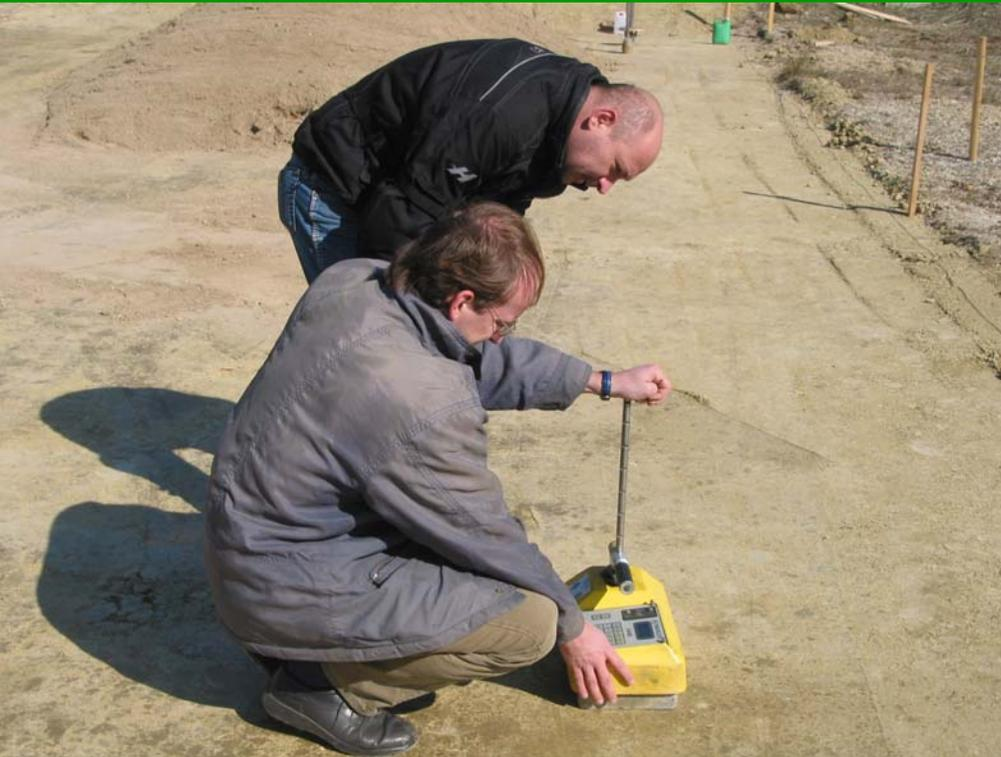
➔ Überprüfen der Verdichtung und des Wassergehaltes
