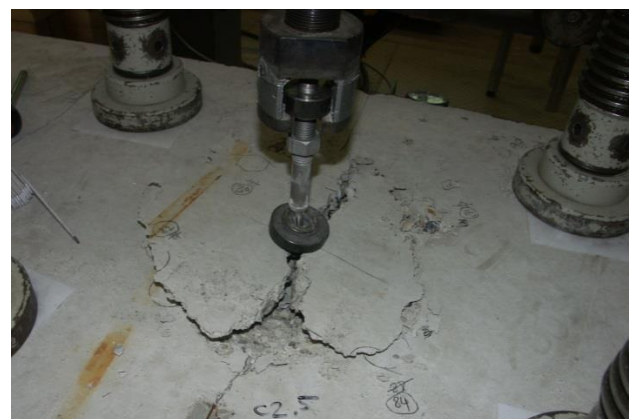
Bild 1 Bestimmung der Resthaltekraft nach durchgeführtem C2.5-Versuch Determination of the residual capacity after a test with crack width cycling
