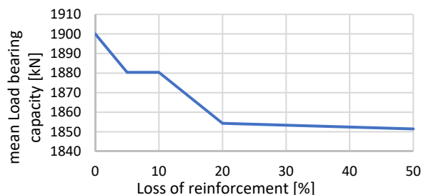
Abbildung 15: Auswirkungen gleichmäßiger Korrosion (Karbonatisierung) auf die Tragfähigkeit
