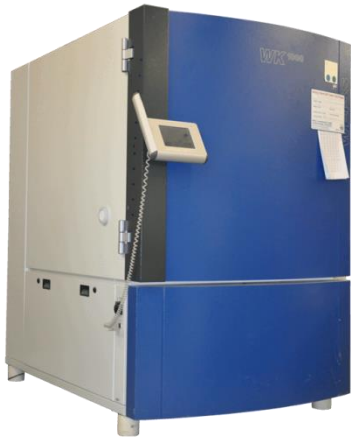
Bild 5: Klimakammer (-40°C bis +180°C)
