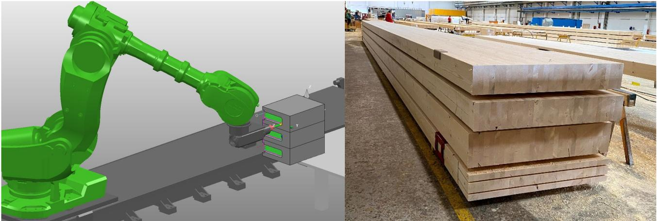
**Abbildung: Links:** Abbund mittels Industrieroboter im Stapel. **Rechts:** Beispiel eines Stapels. → **Ziel:** Deutliche Reduktion im manuellen Abbund, Handling und Logistik.
