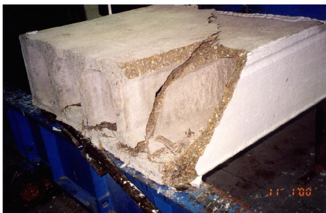
Bild 12 Typisches Versagensbild einer Fertigteilplatte
