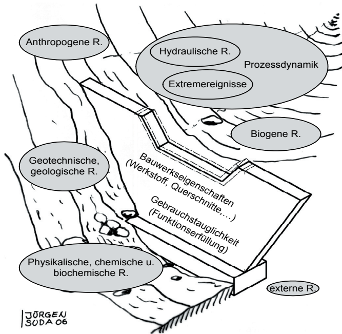
Bild 1: Externe und interne Randbedingungen der Sicherheit eines Ingenieurbauwerkes in der Natur am Beispiel einer Wildbachsperre
