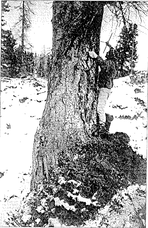
Abb. 2, Mit dem Zuwachsbohrer wird eine 500-jährige Lärche beprobt. (Foto F. Mandl)
