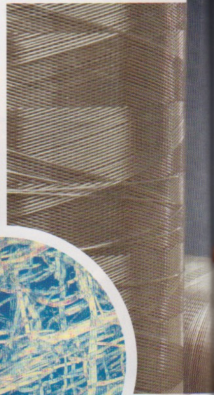
Zellulose. Hohe Zugfestigkeit und sehr biegsam, gleichzeitig hohe Steifigkeit – das macht die Fasern so faszinierend.
