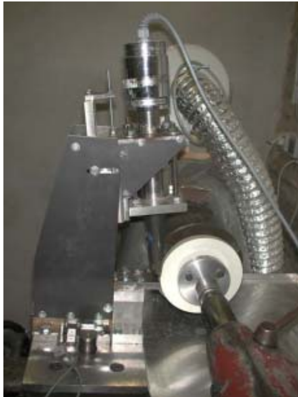
Abb. 3.1.5: Versuchsaufbau zur Bestimmung des Geschwindigkeitseinflusses beim ultraschallüberlagerten Schneiden.
