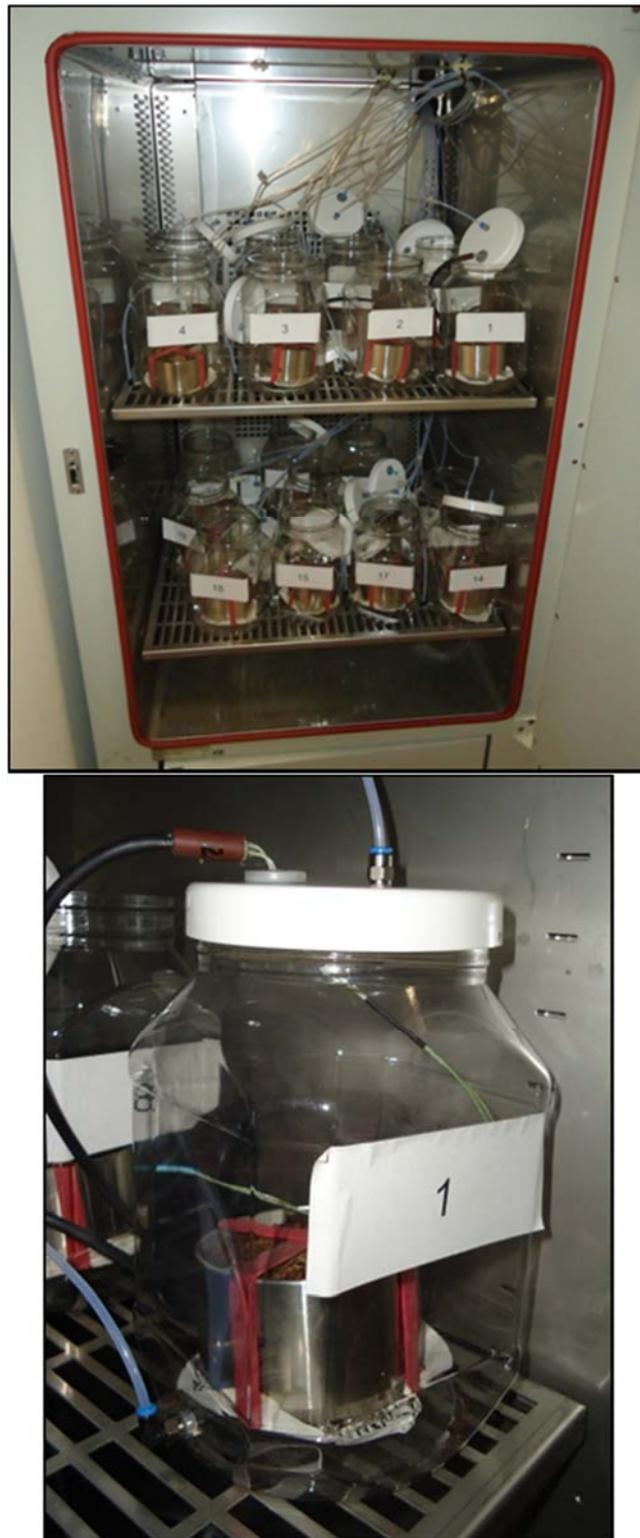
Abbildung 5: Inkubator mit 20 Messkammern zur Messung von Kohlenstoffmineralisierung im Labor.
