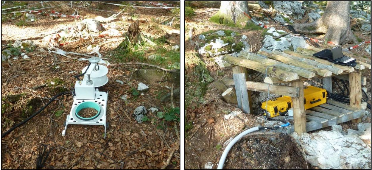
Abbildung 4: Automatische Kammer zur kontinuierlichen Messung der Bodenatmung (links) und Infrarotgasanalysator und Multiplexer (rechts).
