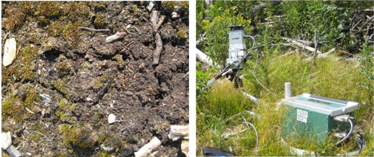
Abbildung 4: Ausgetrocknete Auflagehumusböden (links) und durchgeführte Gaswechsellmessungen (rechts) an Lärche mittels Koniferenkammer (6400-22L, Licor) im Höllengebirge während der Trockenperiode im August 2013.
