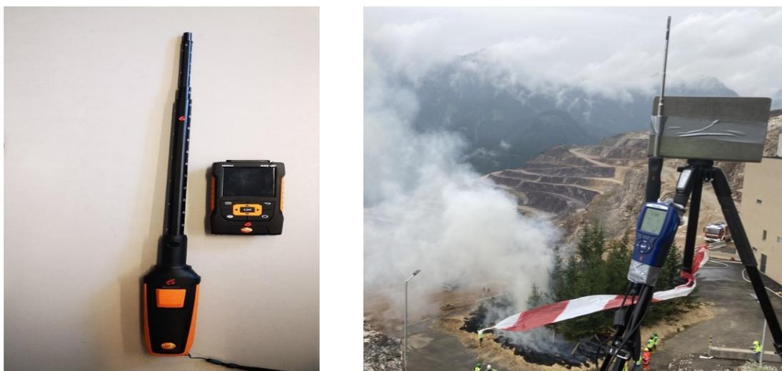
Abbildung 23. Testo 440 dP(links), VelociCalc auf der Etage Süd (rechts)
