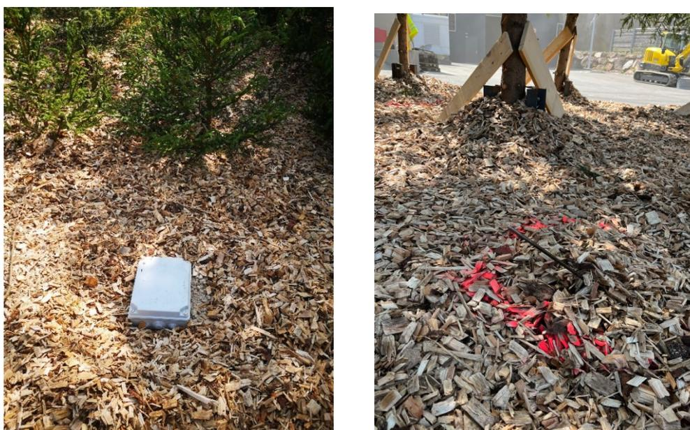
Abbildung 24. Datenlogger (links) und Temperatursonden (rechts)
