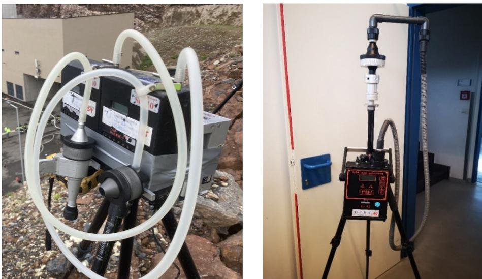
Abbildung 20. SG10 mit Ansaugschlauch während des Versuchs auf der Etage Süd (links), Gravikon PM4-2 im Labor Probenahmekopf (rechts)
