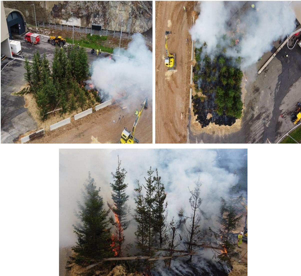
Abbildung 28. Links oben: Entzündung des Brandes mit Messstationen Bagger und Portal direkt im Rauch; Rechts oben: Ausbreitung des Brandes zu den großen Fichten; Unten: Große Brandentwicklung und Abbrand der großen Fichten
