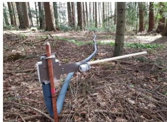
Wetterstation (linkes Bild), Fuel Sticks welche laufend die Streufeuchtigkeit über den elektrischen Widerstand in den Holzstäben messen (rechtes Bild). Fotos: Dipl.-Ing. M. Müller
