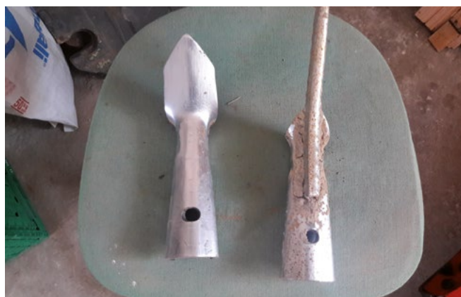
Lockerungsschare (links: 5 cm breit, Lockerung April 2018, rechts: 2 cm breit, Lockerung Mai 2017)
