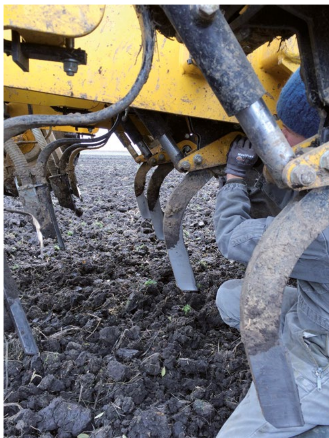
Einstellen der Lockerungszinken
