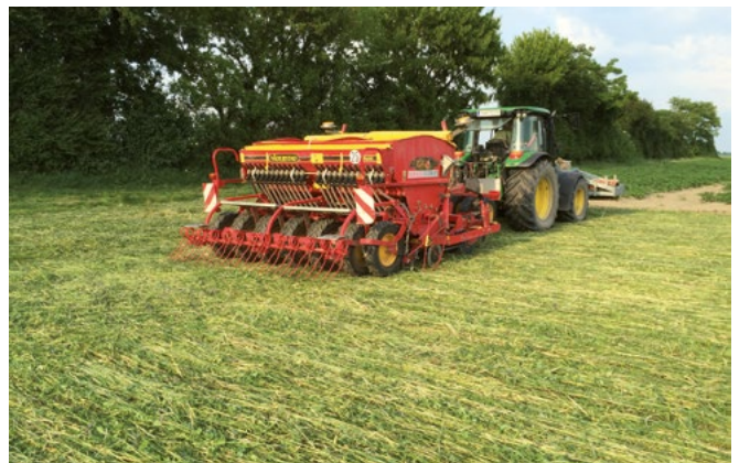
Messerwalze und Direktsämaschine arbeiten gleichzeitig
