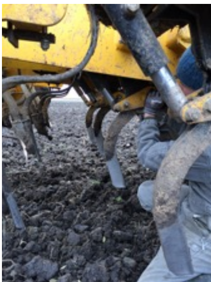
Lockerungszinken auf Zinkensämaschine
