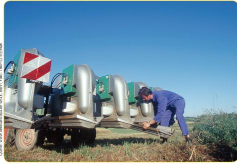
Ein ähnliches Gerät, der „Bio-Collector“, bedient sich der Saugtechnik und wird von der fränkischen Firma Bio-Landtechnik vertrieben. Das Grundprinzip des „Bio-Collectors“ besteht im Abblasen der Kartoffelkäfer und ihrer Larven. Anschließend werden die Tiere in Auffangwannen gesaugt, die abgenommen werden können, um die Käfer zu entsorgen. Das Gerät arbeitet rasch und genau und ermöglicht damit eine effiziente und wirksame Bekämpfung der Schädlinge.
