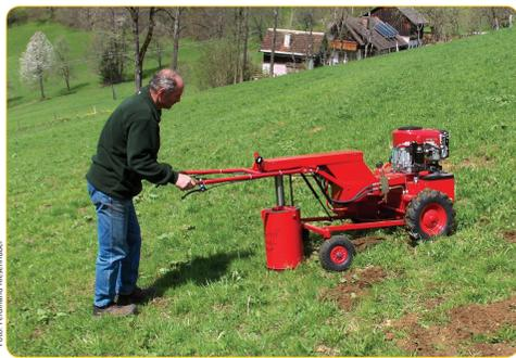
Der Mini-Wuzi ist ebenfalls ein Selbstfahrer mit hydrostatischem Antrieb. Bei diesem Gerät muss der Fräskopf aber durch das Körpergewicht des/r AnwenderIn nach unten gedrückt werden.
