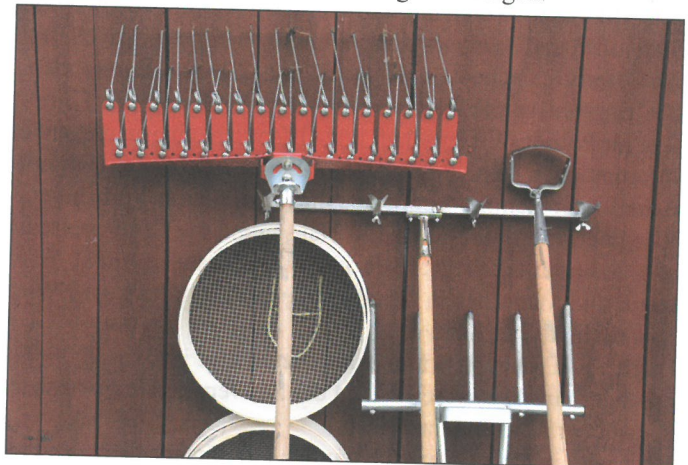
Kleine Auswahl wenig bekannter Handarbeitsgeräte für den Bio-Gartenbau: Handstriegel, Furchenzieher, Pendelhacke, Biogabel und Saatgutsiebe.
