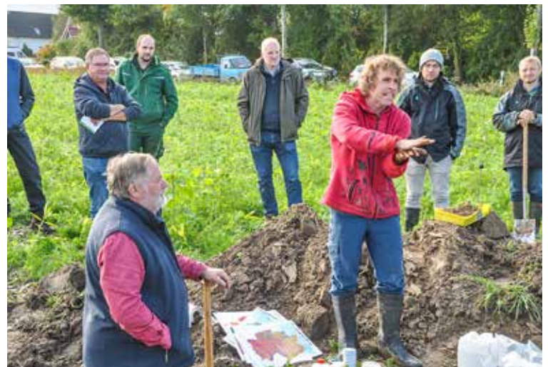
Aus der Profilgrube heraus beobachtet Dr. Ulrich Völker, wie Dr. Gernot Bodner mittels Rollprobe Informationen zur Korngrößenverteilung gewinnt.
