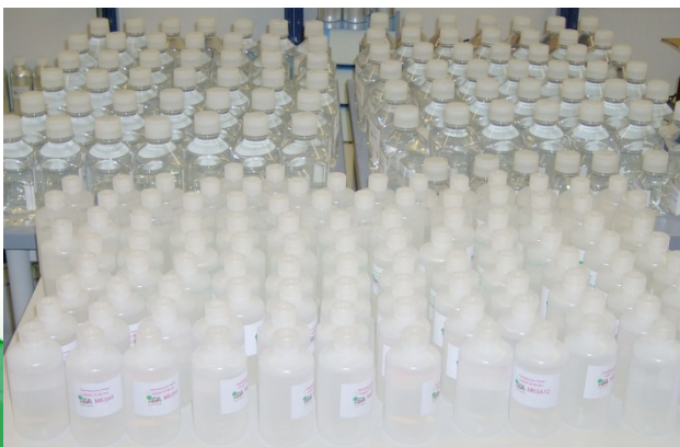
Abb. 2: Am IFA-Tulln hergestellte Ringversuchsproben
