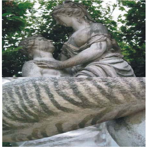
Abb. 3: Marmorfigur im Schlossgarten Schönbrunn (Wien). Die Hydrophobierung des Marmors verursachte das rippenartige Wachstumsmuster der Algen, Pilze und Cyanobakterien.
