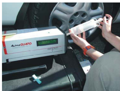
Abb. 2: Einspritzen der Bodenluft in das Messgerät
