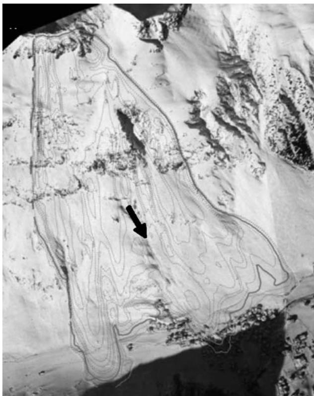
Abb. 8: Darstellung der Druckgrenzen einer Simulation
