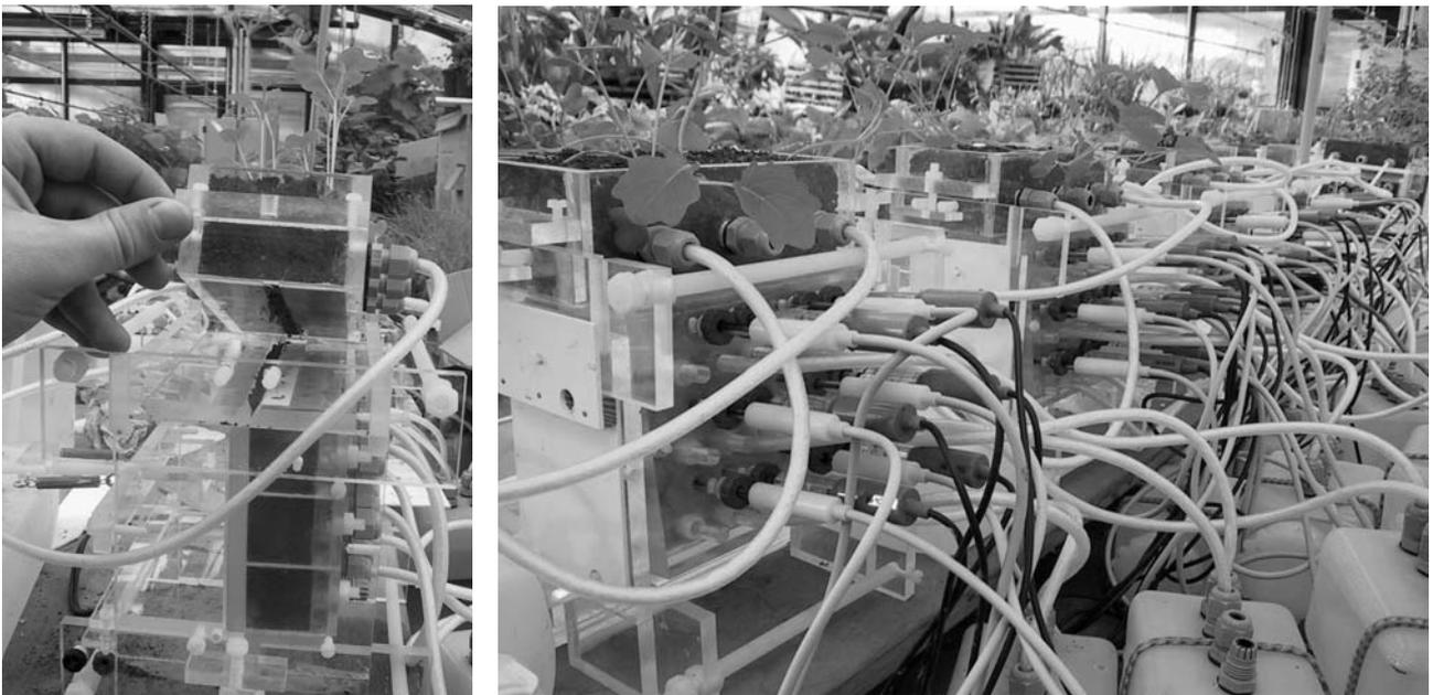
Abb. 1: Seitenansicht des neu entwickelten Rhizobox-Systems, Einsatz von pH und Redox-Mikroelektroden
