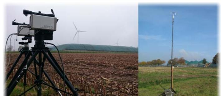
Abb. 3: Einsatz der OP-TDLS zur Konzentrationsmessung entlang einer offenen Messstrecke (links), meteorologische Messungen mittels 3D-Ultraschallanemometer (rechts)
