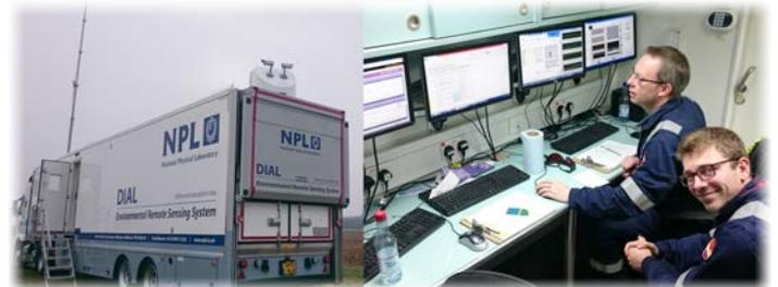
Abb. 5: DIAL-Messung des National Physical Laboratory (NPL) im Einsatz (links: Unterbringung der Messeinheit im LKW, rechts: Steuerung der Messung im Inneren des LKWs)
