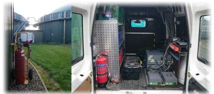
Abb. 4: Beispielhafte Ausstattung für die Dynamische Tracermethode mittels Cavity Ring Down Spektrometer (CRDS) (links: kontrollierte Freisetzung des Tracergases innerhalb der Biogasanlage, rechts: Messeinheit im PKW)
