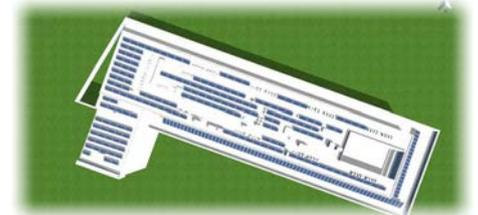
Abb. 4a: Ertragreichste PV-Modulanordnung am Dach des Simon-Zeisel Hauses; Darstellung aus PV-Sol. (Quelle: MA, Weindl K.)
