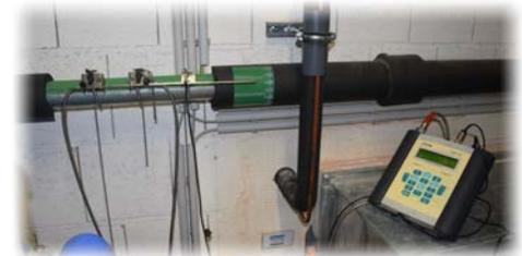
Abb. 3: Ultraschallmessung des Volumenstromes mit Flexim Fluxus F601 am Kaltwassernetz des Armin-Szilvinyi Hauses (eigene Darstellung).
