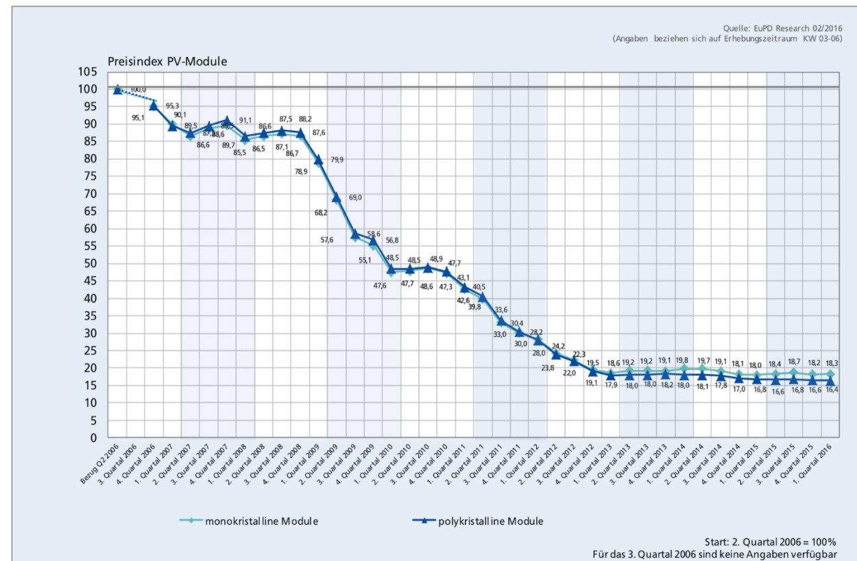
Abb. 12: Entwicklung der durchschnittlichen Modulpreise für Photovoltaikanlagen 2006 - 2016. Quelle: EuPD Research International Solar (2018) [5]
