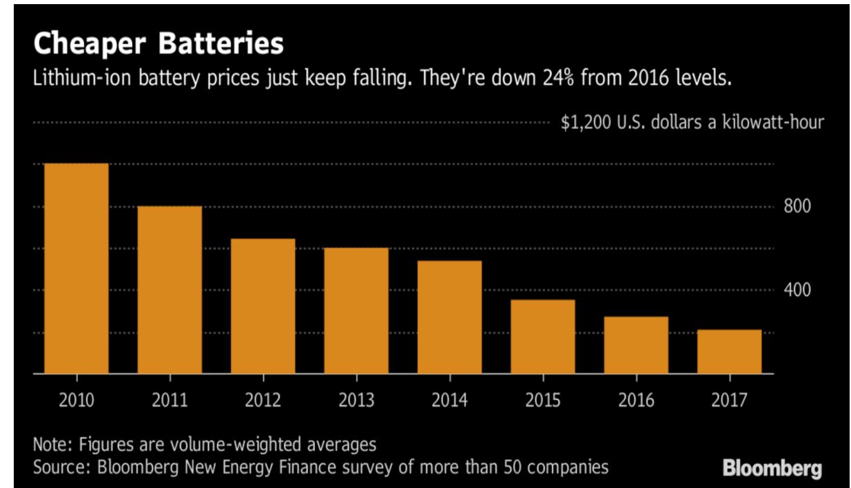
Abb. 13: Entwicklung der durchschnittlichen Preise für Fahrzeugspeicher auf Systembasis. Quelle: Bloomberg Technology (2018) [6]
