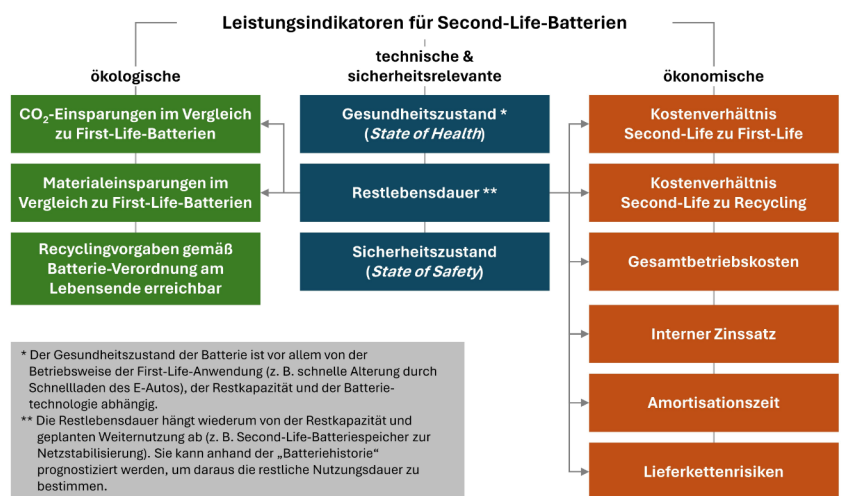
Abb. 3. Überblick: für SLB-Anwendungen identifizierte KPIs (ökologische, technische und sicherheitsrelevante sowie ökonomische Leistungsindikatoren). Grafik wurde auf Basis der Ergebnisse von Prenner et al. (2024) erstellt. 11
