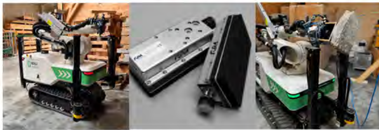
Abbildung 1: Von Links: BOKU Baubot MRS-15 Mobile Robotereinheit; FIPA Vakuumgreifer; Baubot mit Vakuumgreifer und Naturstein
